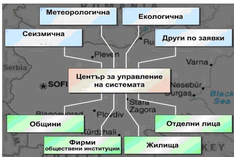
Фиг. 3. Принципна структура на системата за ранно оповестяване на природни бедствия
